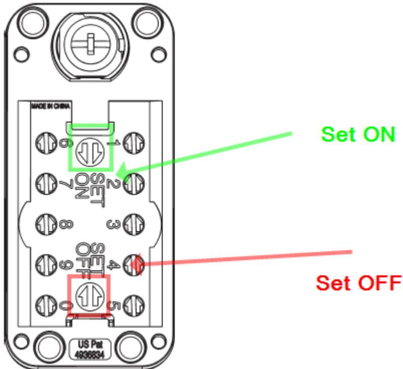
4) Auslieferungszustand: Alle Pfeile an den Schrauben zeigen nach oben, da keine voreingestellte Kombination vorhanden ist.
